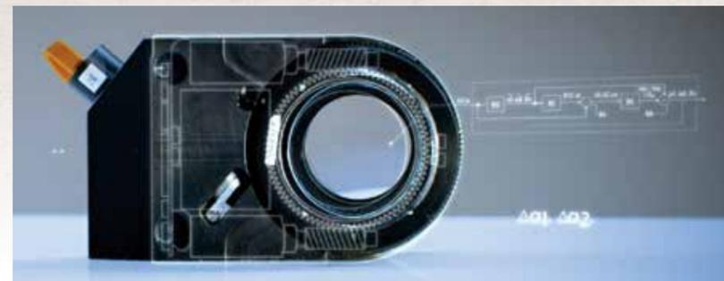
「液体レンズ」と「補助レンズ」を自在にコントロールできる光学モジュールを使用し、球面度数/乱視度数/乱視軸をシームレスに変化させ測定します。
